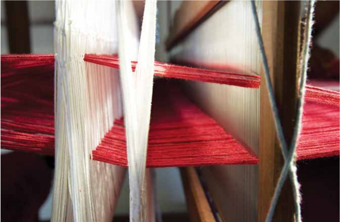
Vista lateral dos pentes e liços
