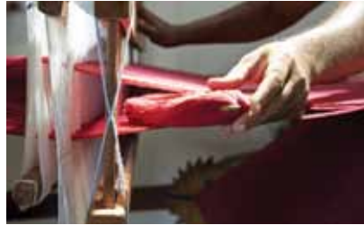
Laçadeira sendo lançada por entre os fios para compor a trama
